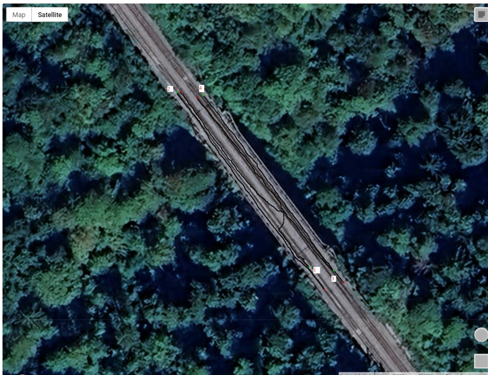
Sliki 3: Dispozicija georadarskih profilov izvedenih na Dolskem viaduktu. Začetne točke georadarskih profilov so označene z zeleno, končne pa z rdečo.
